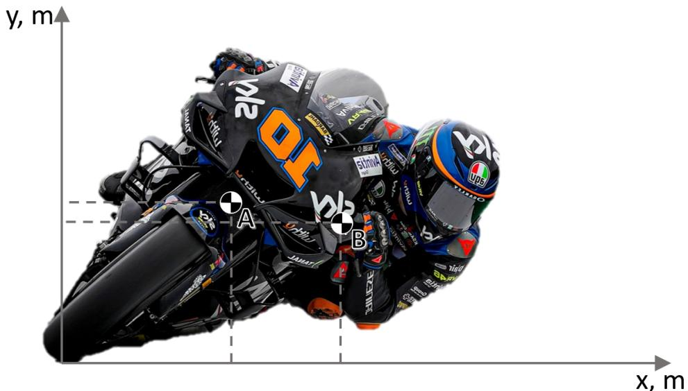
**B1:** Zināms, ka motocikla masas centrs atrodas punktā  $A = (0.4; 0.4)$ , bet motociklista masas centrs ir punkts  $B = (0.7; 0.35)$ . Motocikla masa ir  $176 \text{ kg}$ , bet pats motociklists sver  $72 \text{ kg}$ .
